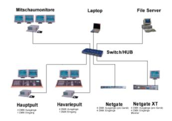
CSMA/CD (Carrier Sense Multiple Access/Collision Detection), die nach einem "Cocktail Partv Algorithmus" arbeitet, bei der nach der "Methode der brutalen Gewalt" jede Station im Netzwerk versucht ihre Daten ohne Rücksicht auf andere loszuwerden. deuten auf die Gefahren des Ethernets hin. Hier ist neben einer konsequenten Normungsarbeit eine auch entsprechenden Ausbilduna der Mitarbeiter in den Theatern und Spielstätten erforderlich.
